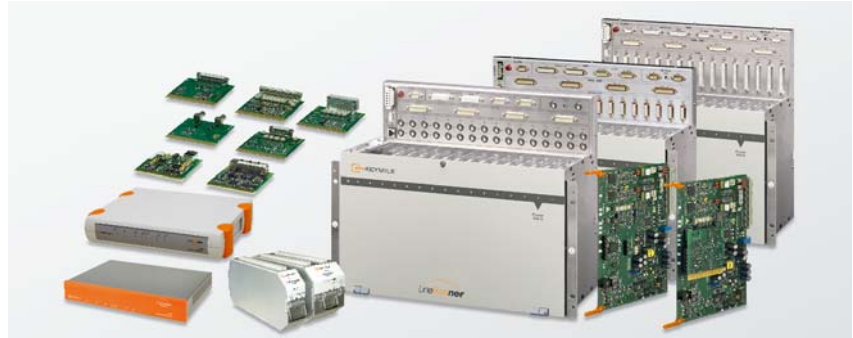
Bild 3: Baugruppen des SHDSL-Übertragungssystems: DTM, LCM und Subracks
